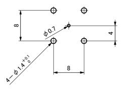
2. パネル取付穴寸法 図2を参照ください。一般公差は±0.05mm。 (注)パネル取付用ねじは、M2.6のねじを使用してください。パネル厚さは、1.6mm以下。
