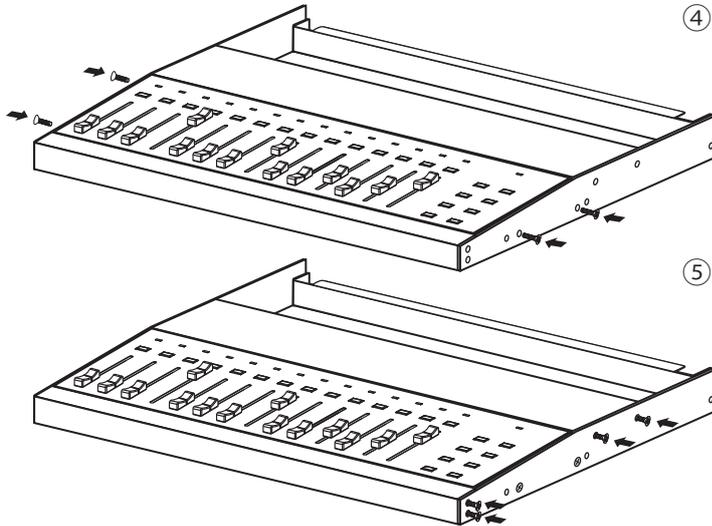
④ ミキサー操作ユニットを付属の皿小ネジで左右4ヶ所を固定します。
