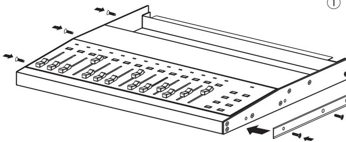
① スライドユニット部の左右のスライドレールのネジを6ヶ所固定し、スライドレールを固定します。
