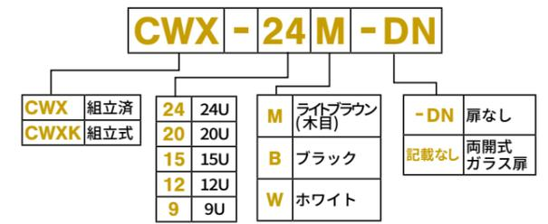
[扉付き] 扉開閉270°側板吸着 最上部鍵付 扉強化ガラスNSG製 ・標準で「両開式ガラス扉」を付属しています。(組立済)も付属の扉は組み付けが必要です。
