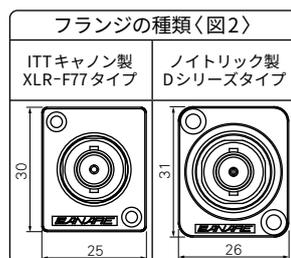
BCJ-RUC1の中心コンタクトははんだ付けです。また、圧着スリーブの加工には当社製圧着工具(TCD-1DB)を使用してください。(66ページ)
